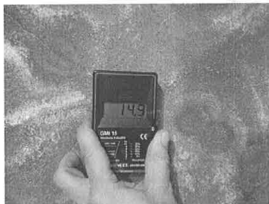
6. ábra: Falfelületi nedvesség mérés. A szerző felvétele.
