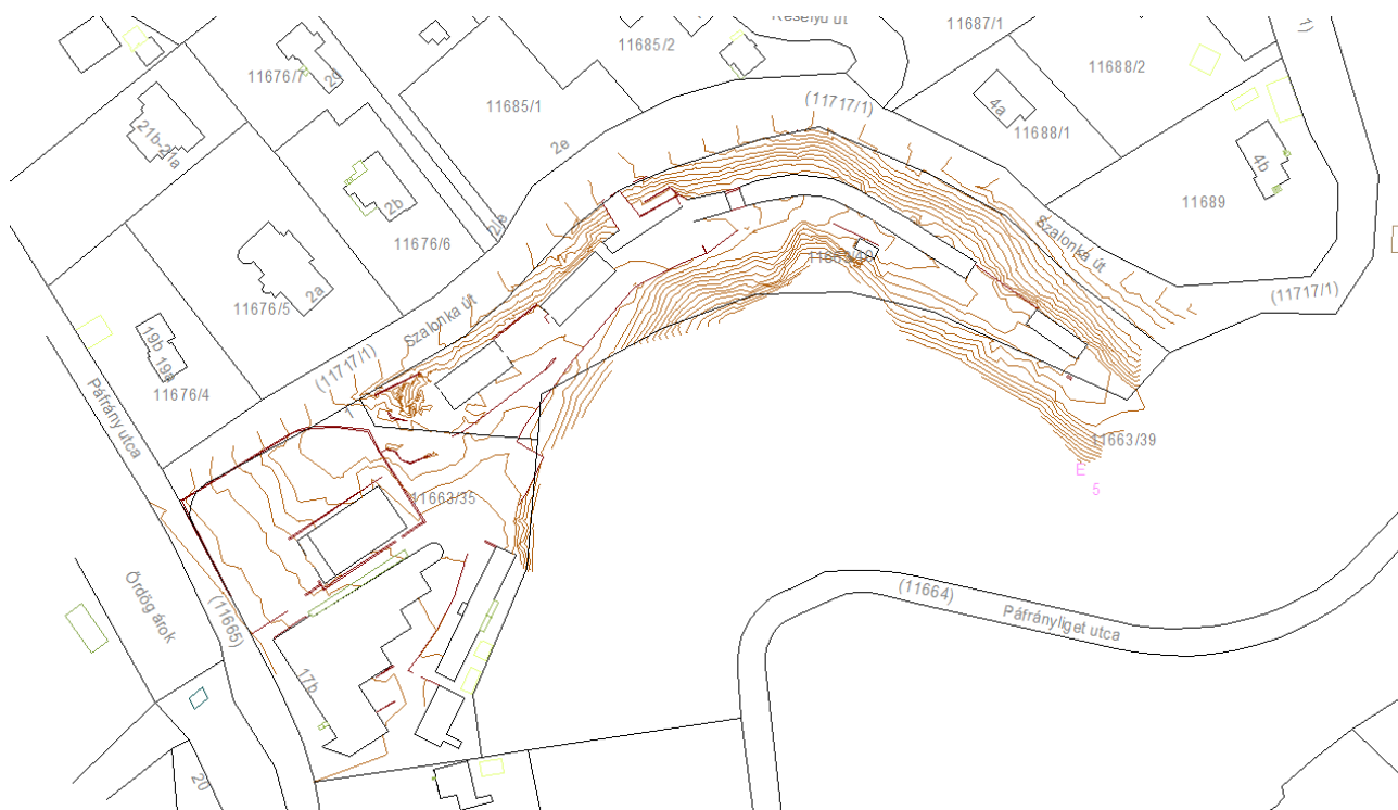
2. ábra: A terület alaptérképe, geodéziailag felmért rétegvonalakkal
